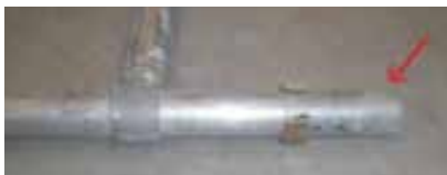
Ingen förstärkningsring på gavelräckesramen
