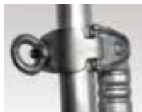
Koppling i gott skick, gummi på den ledade foten
