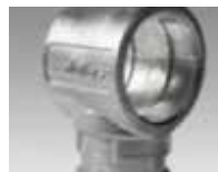
Kallpressningskoppling i gott skick
