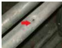
Hål i vertikala rör på ramen
